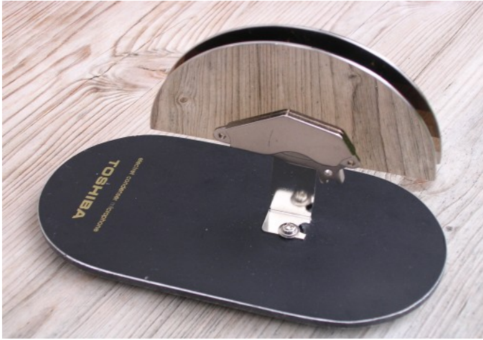
Festplattenkugelschreiberständer 2004. Die Festplattenhalterung für Notizen wird im oberen Teil stabil durch Magnete getragen und benötigt erst im unteren Teil eine einzige Schraube.
